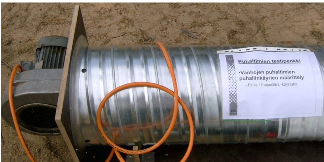
Puhaltimien testaukseen rakennettu laitteisto
