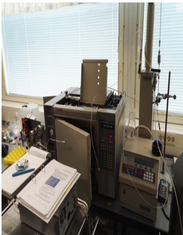
Kuva 7. Laboratoriomittakaavan uuttolaitteisto ylikriittisiin CO 2 -uuttoihin. Kuva: Risto Korpinen.
