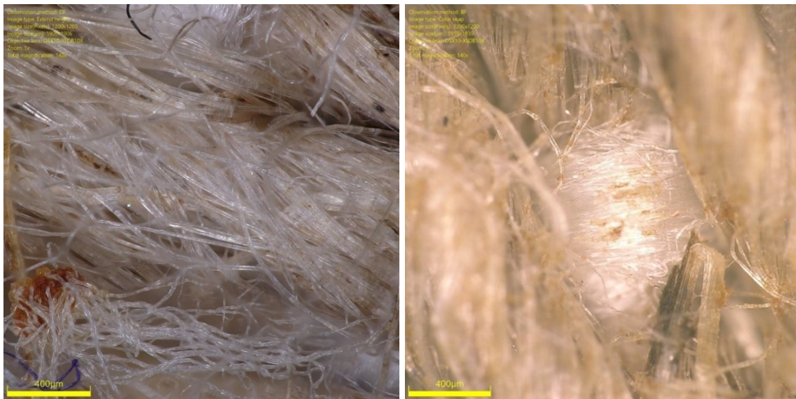
Kuva 24. Kuvassa vasemmalla käsittelemätön jacquard-tekstiili (puuvillakuidut kuvassa valkoisia ja pellavakuidut ruskeita) ja oikealla väinönputkenöljymikrokapseleilla käsitelty jacquard-tekstiili. Kuvat: Kalle Kaipainen ja Susan Kunnas.
