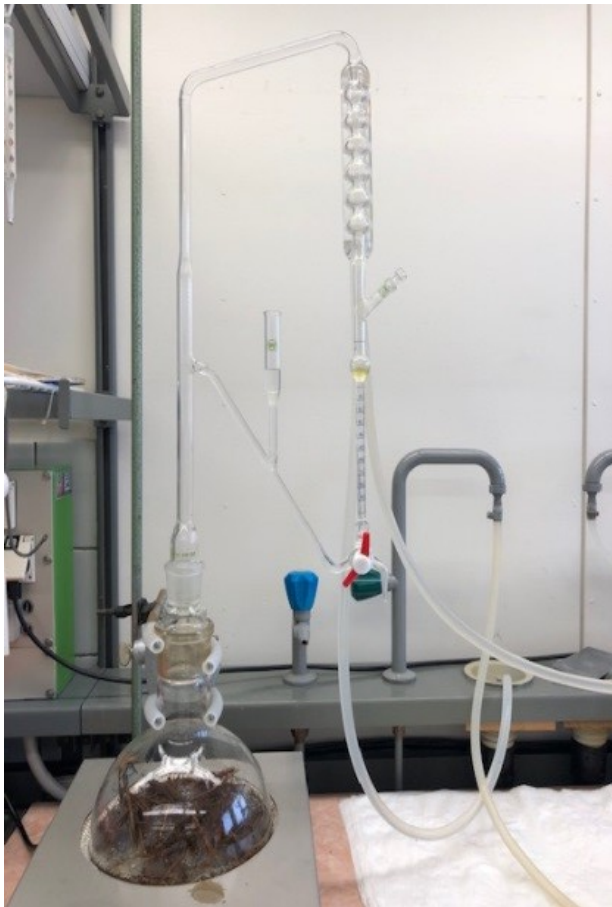
Kuva 6. Clevengerin tisluslaitteisto ja -menetelmä. Kuva: Susan Kunnas.
