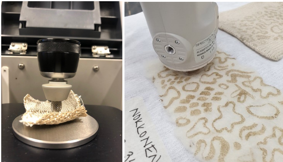
Kuva 18. Vasemmalla kuvassa käsitelty jacquard-tekstiilinäyte ATR-mittauksessa ja oikealla käsitelty neulahuovutettu villanäyte värimittauksessa. Kuvat: Susan Kunnas ja Virpi Kemppainen.
