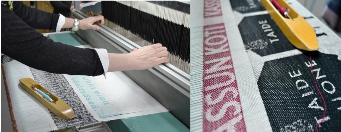
Kuva 10. Yritystyöpajassa 1 yrittäjät siirsivät oman yrityksensä logon ArahWeave -kudontaohjelman kautta tekstiiliin kudottavaan muotoon. Kuva: Emma Napari.
