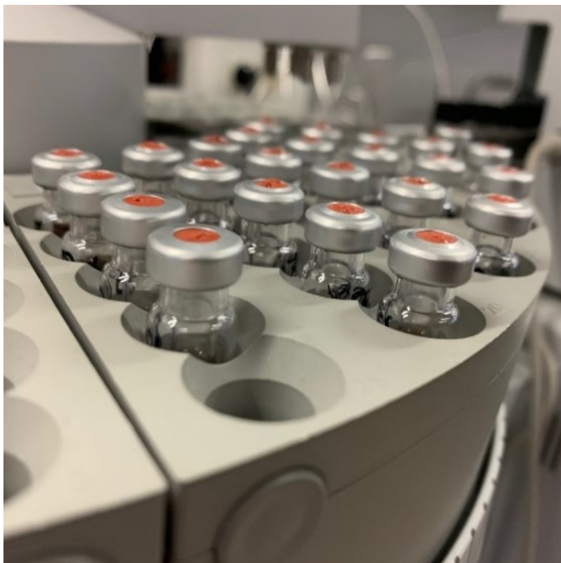
Kuva 8. Näytteet kromatografisessa analyysissa GC-MS-laitteistossa. Kuva: Risto Korpinen.
