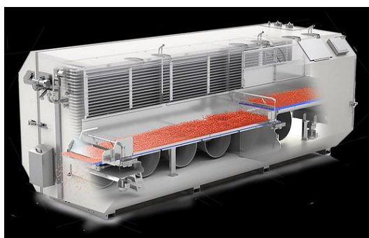
Kuva 46. Tunnelipakastuksessa raaka-aine jäätyy noin 1 cm tunnissa.
