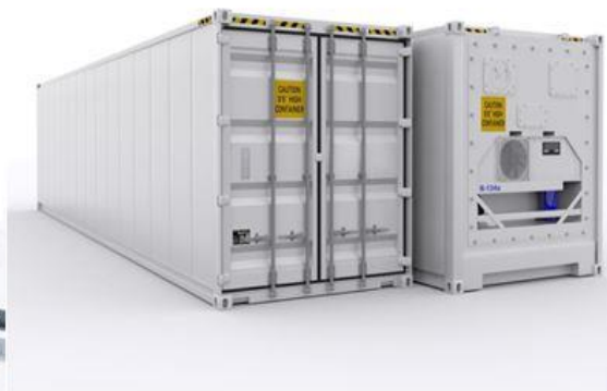
Kuva 32. Pakastekärry toimii omana kuljetusyksikkönä ja sitä voi kuljettaa B-ajokortilla. Pakastekontit kuljetetaan rekka-autoilla. Pakaste- ja kylmäkontteihin mahtuu raaka-aineita 6–70 m 3
