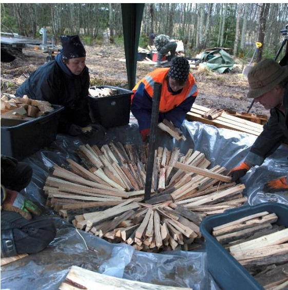
Kuva 64. Tervaa tuotetaan tervahaudoissa latomalla pihkottuneita männyn pilkkeitä keskiosaa kohti.
